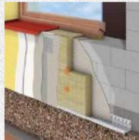
Теплоизоляция кровли и наружных стен
